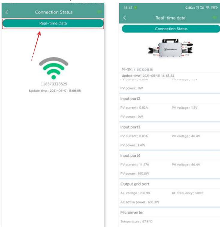
Remarque : si le signal du micro-onduleur n'est pas détecté, vérifiez que le micro-onduleur est allumé ou reportez-vous au manuel d'utilisation du micro-onduleur pour résoudre le problème.
