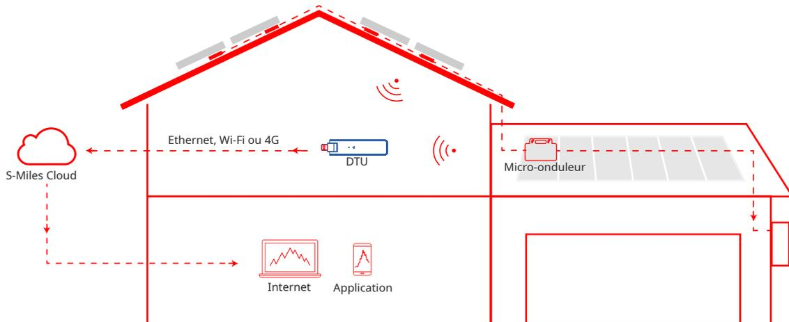
Le système complet de micro-onduleur photovoltaïque de Hoymiles est composé d'un micro-onduleur photovoltaïque, d'une passerelle DTU et de la plateforme S-Miles Cloud de Hoymiles.
