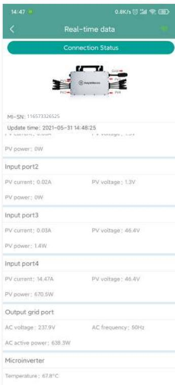
Remarque : si la puissance du signal du micro-onduleur est trop faible pour que les données ne s'affichent pas en temps réel, rapprochez la DTU du micro-onduleur.
